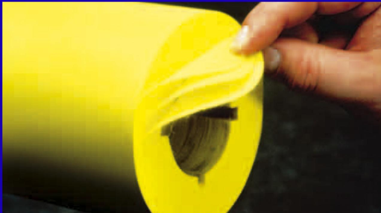
I rivestimenti in fibre ingarbugliate dei rulli JVM constano di sottili dischi in fibre sintetiche non tessute, uniti da una resina flessibile e resistente, espressamente messa a punto per questa applicazione.
